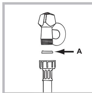
1. Вставьте прокладку A в конец заливного шланга и наверхните его на вывод водопровода холодной воды с резьбовым отверстием 3/4 дюйма (см. рис.).
