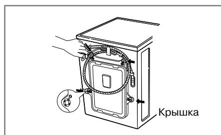
4. Закройте отверстия прилагаемыми крышками.
