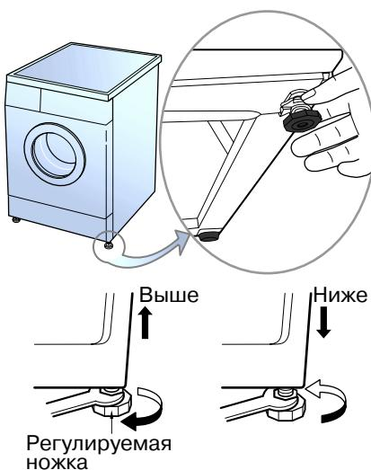
2. Если пол неровный, обеспечьте горизонтальное положение стиральной машины при помощи регулируемой ножки. (Не следует для выравнивания положения подкладывать под ножки куски древесины и т.п.) Убедитесь, что все четыре ножки твердо стоят на полу, а затем проверьте горизонтальное положение стиральной машины (при помощи спиртового уровня).
