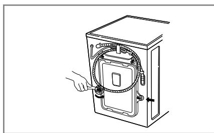
2. Отвинтите 4 болта при помощи гаечного ключа, который входит в комплект поставки машины.
