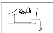
2. Выньте дренажную пробку (②), чтобы остатки воды стекли. Подставьте какой-нибудь сосуд, чтобы вода не попала на пол. Когда вода перестанет течь, откройте фильтр дренажного насоса (③), повернув его против часовой стрелки.
