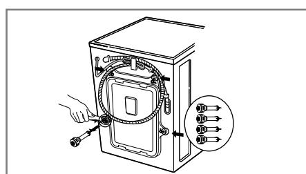
1. Для предотвращения повреждения внутренних деталей машины при транспортировке в машине закреплены 4 транспортировочных болта. Перед началом эксплуатации машины эти болты необходимо удалить вместе с резиновыми заглушками.
