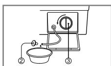
3. Выньте все посторонние предметы из фильтра (③). После чистки поверните фильтр (③) по часовой стрелке и вставьте на место дренажную пробку (②). Закройте дверцу на нижней панели.
